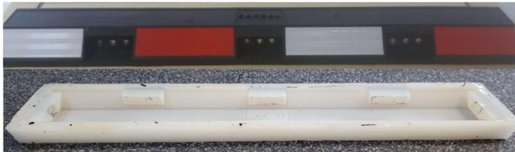
En partant d'un master, vous réalisez un moule en silicone afin d'obtenir la forme souhaitée par le client.
