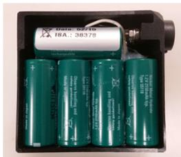
Ce bloc piles sans complètement anodin et pourtant la géométrie d'implantation des piles, le film apposé sur les piles, la colle utilisée par le sous-traitant posent des problèmes d'enrobages.
