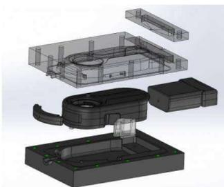
Ce moule fermé, complexe, avec différentes matières permet l'enrobage d'une plasturgie, d'une électronique, d'un connecteur et d'un emplacement pour un bloc piles. L'aspect de la pièce terminée est proche d'une injection plastique classique.
