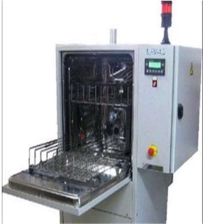
Le lavage en machine, plus industriel, toujours avec une solution aqueuse permet de traiter un batch en 1h-1h15, séchage compris.
