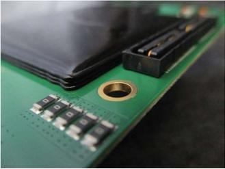
Ici, on voit parfaitement le cordon qui est réalisé sous forme de mur, empêchant ainsi la résine d'aller sur certaines zones de la carte
