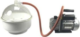
Une bonne solution pour extraire l'humidité dans une résine, le dégazage, soit le passage en pompe à vide. La vidéo du slide suivant montre un silicone avant mélange.
