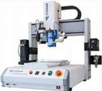
La dépose de résine, de gouttes de colle ou la dépose sélective « dam and fill » est largement facilitée par un robot sous réserve d'une bonne anticipation de l'implantation de la carte, de l'outillage de posage et d'une programmation adaptée.
