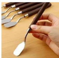
Le mélange à la main est loin d'être le meilleur car il introduit beaucoup d'air dans le produit, n'est pas homogène et il y a un fort risque de mauvais mélange avec les bords du contenant.
