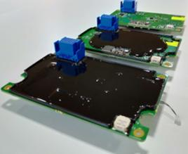
Une protection en couche épaisse comme on en voit la progression ici, montre le recouvrement du pcb avec 2 mm de résine sur l'ensemble du pcb. Attention toutefois à l'implantation de certains composants.
